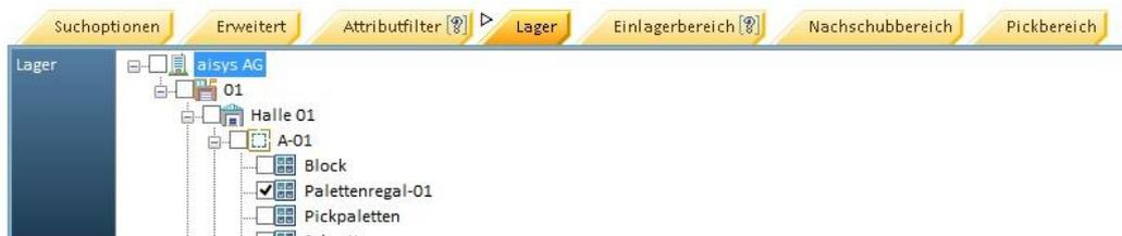
In diesem Beispiel wird die Suche auf Lagereinheiten eingeschränkt, die im Lager aisys AG in Halle 01 im Abschnitt A-01 im Palettenregal 01 liegen.
